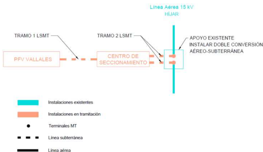
Ilustración 1: Infraestructuras de evacuación del parque fotovoltaico
